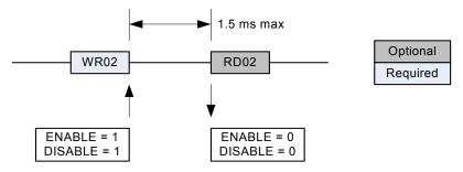
Figure 9. Powerdown Timing
