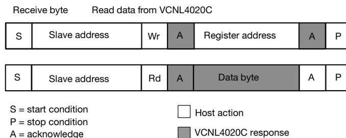
Fig. 14 - Send Byte / Receive Byte Protocol
