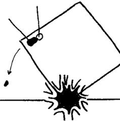
THEN BANG THE BOARD AGAINST YOUR WORK TABLE TO FLING THE EXCESS MOLTEN SOLDER TO THE TABLE
