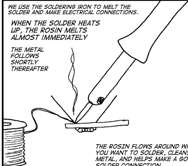
THE ROSIN FLOWS AROUND WHAT YOU WANT TO SOLDER, CLEANS THE METAL, AND HELPS MAKE A GOOD SOLDER CONNECTION.
