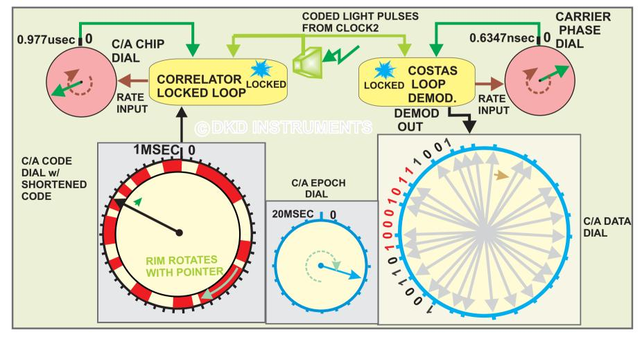
ALL PHASES TAKEN AT THE INSTANT REFERENCE CLOCK IS AT ZERO TIMING MARK
